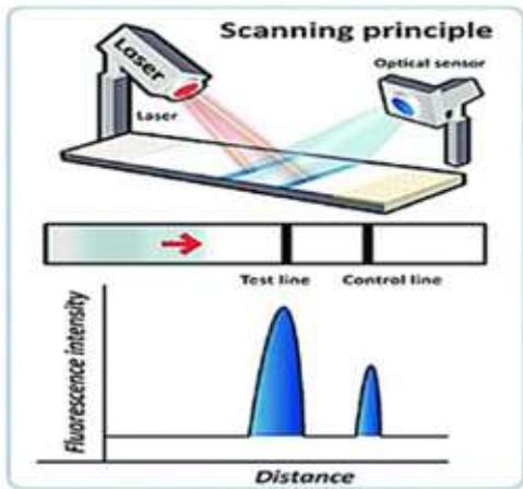
FIGURA 5.B. STRUMENTAZIONE PER DOSAGGIO SEMIQUANTITATIVO IFA
